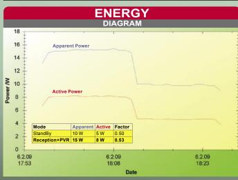
Ersten 15 Minuten: aktiver Betrieb mit Kanalwechsel, Aufnahme, Wiedergabe etc., zweiten 15 Minuten: StandBy
